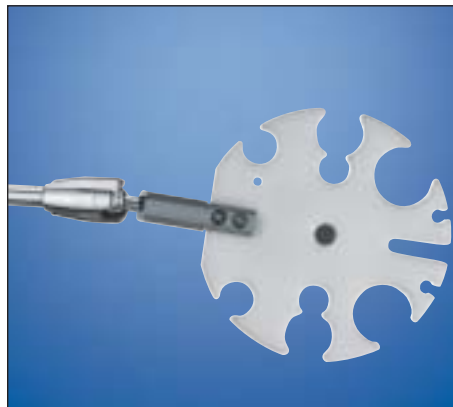
Das Aufsatz-Zubehör zu diesen Armsystemen wie Endoskophalterungen oder Schlauchhalterungen wird mit einem M-8 Gewinde aufgeschraubt und durch eine Kontermutter gesichert
